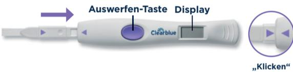
**c** Warten Sie vor dem Test, bis das Symbol „Test bereit“ angezeigt wird.
