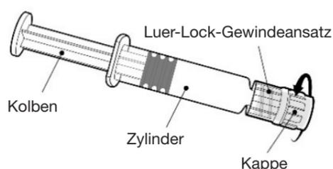
Halten Sie die Spritze am Zylinder, nicht am Kolben.
