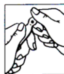
Abb. 1 Unterhalb des Punktes ist die Sollbruchstelle.
