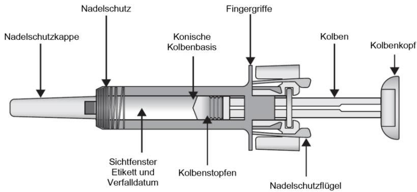
Nach der Injektion des Arzneimittels wird der Nadelschutz aktiviert, um die Nadel abzudecken. Der Nadelschutz schützt medizinisches Fachpersonal, Pflegepersonen und Patienten vor versehentlichen Nadelstichverletzungen nach der Injektion.
