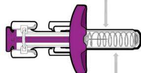
Jede Fertigspritze hat einen Nadelschutz. Dieser deckt die Nadel automatisch ab, nachdem der Kolben bis zum Anschlag nach unten gedrückt und dann losgelassen wurde.
