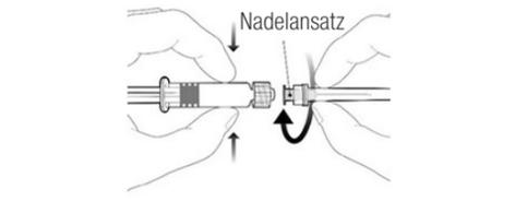
Um die Nadel anzubringen, verbinden Sie den Nadelansatz mit dem Luer-Lock-Gewindeansatz und drehen Sie um eine Vierteldrehung im Uhrzeigersinn, bis die Nadel spürbar einrastet.
