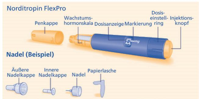
Ihr Norditropin FlexPro Pen ist ein Wachstumshormon-Fertigpen. Norditropin FlexPro enthält eine Lösung mit 5 mg humanem Wachstumshormon und gibt Einzeldosen von 0,025 mg bis 2,0 mg in Schritten von 0,025 mg ab. Norditropin FlexPro ist zur Verwendung mit NovoFine oder NovoTwist Einweg-Nadeln bis zu einer Länge von 8 mm vorgesehen.
