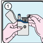
1) Öffnen Sie das Etui. Überprüfen Sie das Verfalldatum auf dem Etikett des Kartuschenbehälters. Verwenden Sie die Kartuschen nicht nach Ablauf des Verfalldatums. Entfernen Sie die Versiegelung von **einem** der beiden Behälter der Nachfüllpackung und klappen Sie die Verschlusskappe auf.
